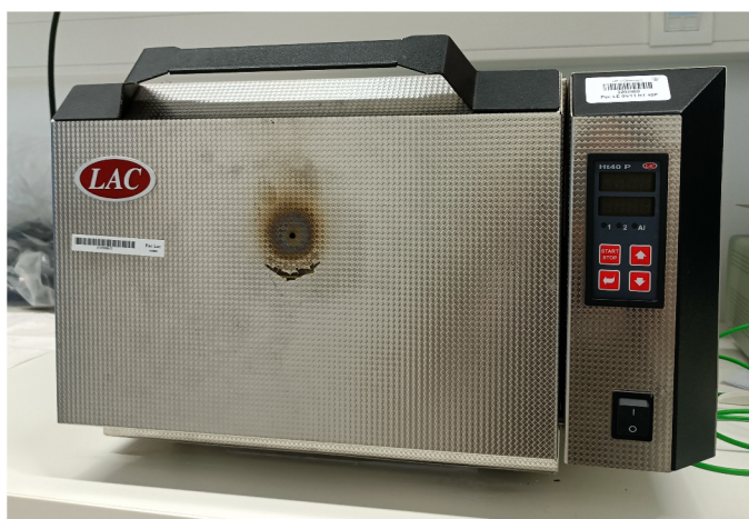
Obrázek 15: Laboratorní komorová pec LAC05/11
