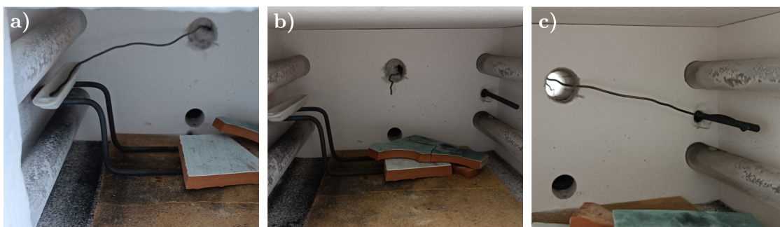
Obrázek 16: Fotografie umístění termočlánku pro případy a) v lodičce podél topných těles, b) uprostřed komory pece, c) omotaný kolem teplotního čidla zabudovaného v komoře pece
