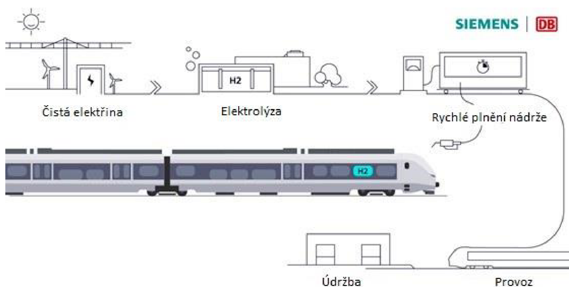
Obr. 2.8 Schéma zbrojení vodíkem
