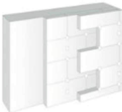
Obr. č. 50: Montáž izolantu na vazbu; zdroj: www.weber-terranova.cz
