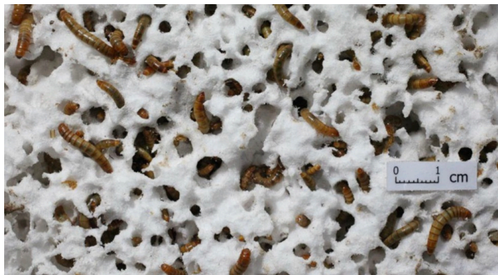
Obr. č. 15: Larvy potměníka moučného při odstraňování pěnového polystyrenu; zdroj: www.epscr.cz
