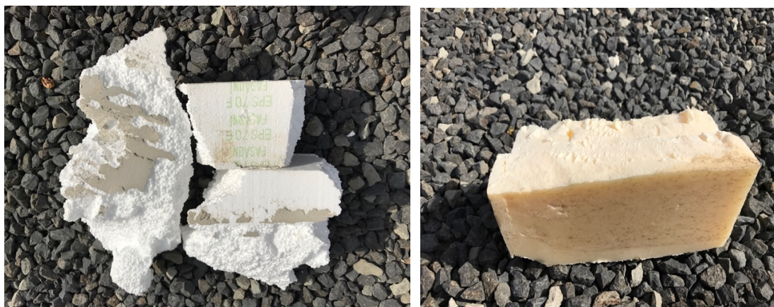
Obr. č. 59 vlevo: Expandovaný pěnový polystyren EPS 70 F – izolační materiál; zdroj: vlastní Obr. č. 60 vpravo: Extrudovaný pěnový polystyren XPS – plasty; zdroj: vlastní
