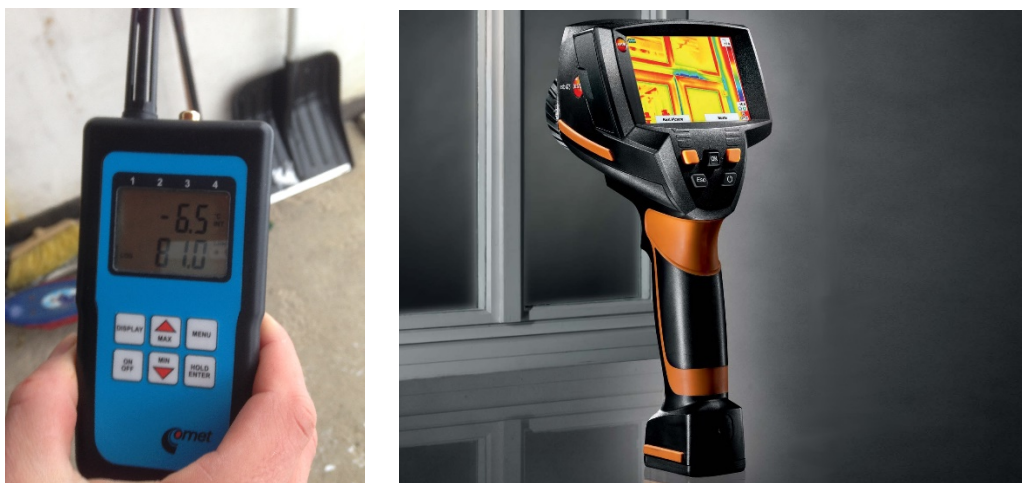
Obr. č. 20 vlevo: Teploměr s vlhkoměrem Comet-C3120; zdroj: vlastní
