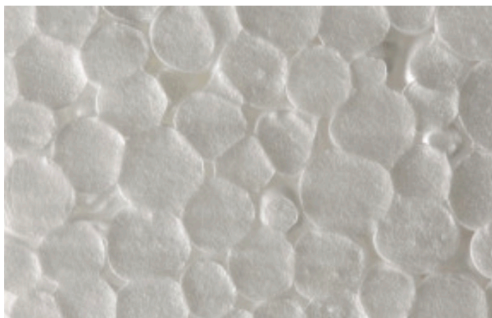
Obr. č. 6: Struktura pěnového polystyrenu; zdroj: www.epscr.cz
