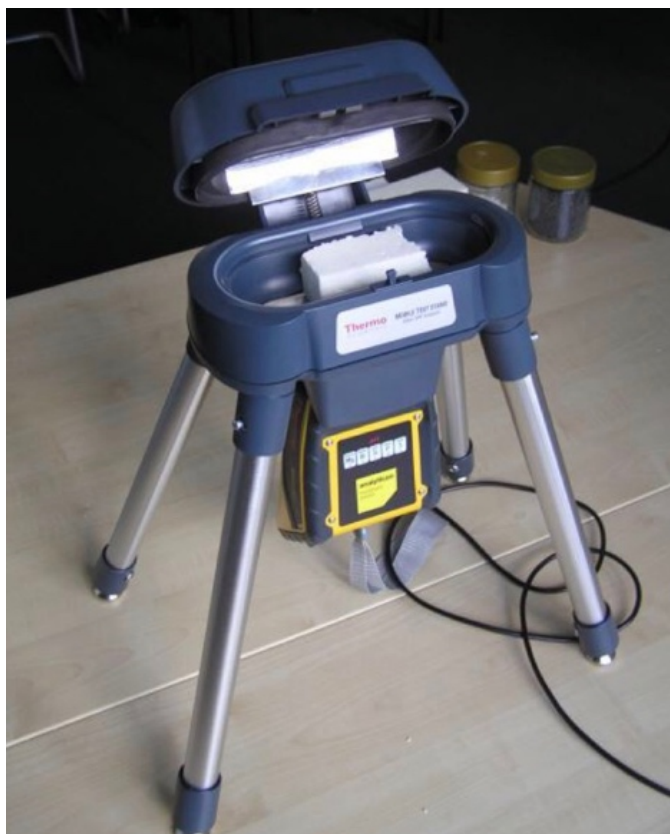
Obr. č. 61: Přenosný přístroj na měření koncentrace HBCD; zdroj: www.epscr.cz
