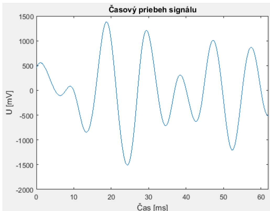
Obr. 5-10: Zosilovač, prvá varianta, mávanie rukou
