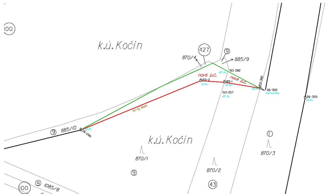
Obr. č. 15 - nesoulad stavu v terénu se stavem v KN
