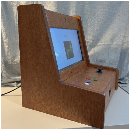
Obrázek 5.3: Vyrobená herní konzole z boční strany
