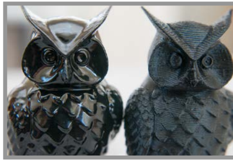
Obr. 4 Vyhľadzovanie ABS pomocou acetónu[7]
