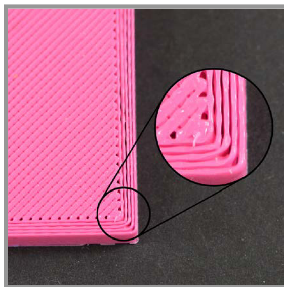
Obr. 18 Nedostatočný objem vytlačaného materiálu[26]
