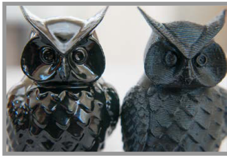
Obr. 4 Vyhľadzovanie ABS pomocou acetónu[7]
