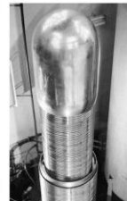
Legendární Van de Graaffův generátor byl v roce 1920 vyvinut pro potřeby fyzikálních experimentů.
