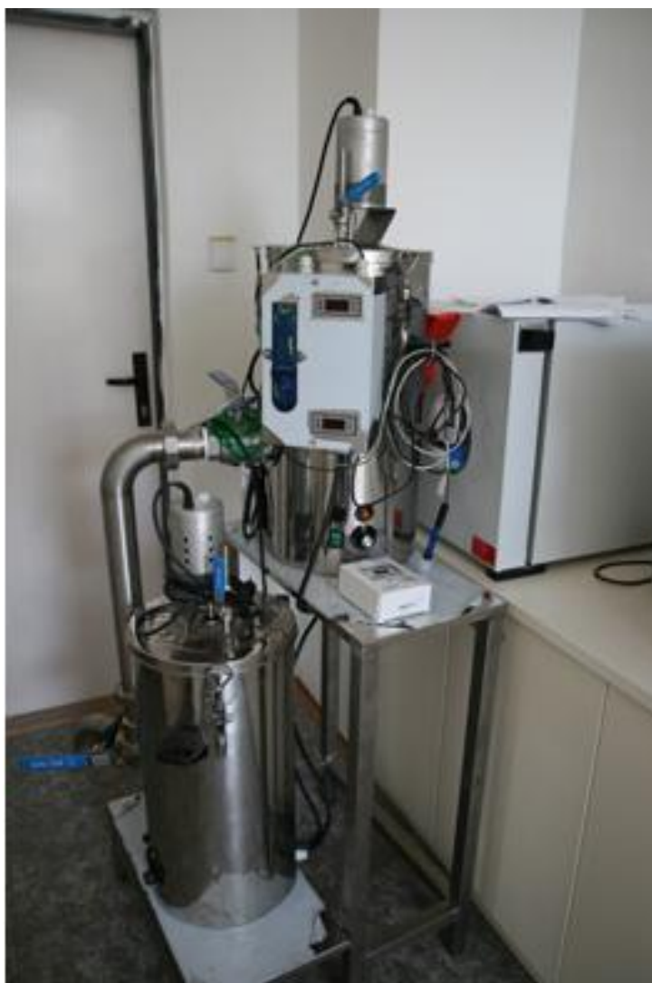
Grafika 8: Automaticky monitorovaný anaerobní fermentor Stix.
