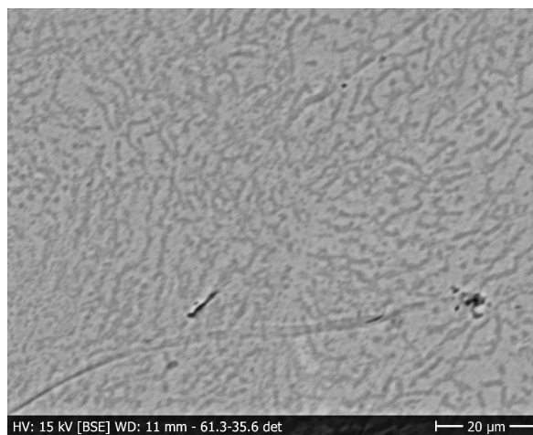
Obr. č. 33: Detail struktury částečně vylouženého pseudorutilu z obr. 33a, BSE (EMPA).
