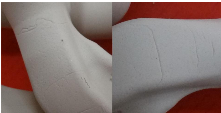
Obr. 9 Studené spoje na povrchu jádra
