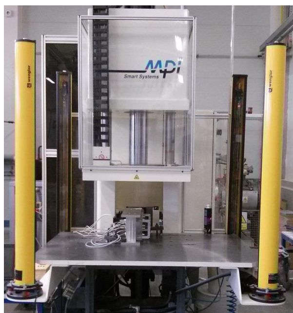
Obr. 43 Umístění formy mezi razníky vstřikolisu
