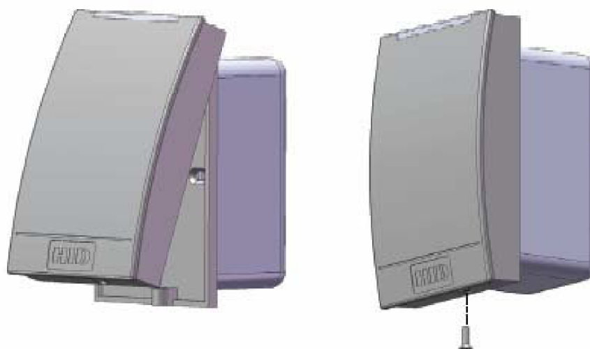
Obr. 14) Montáž čtečky obsahující detekci manipulace [32]
