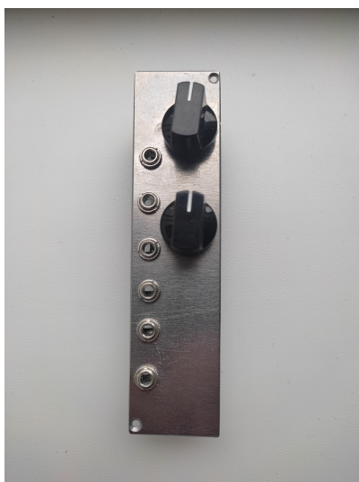
Obr. 3.3: Realizovaný modul napětím řízeného zesilovače
