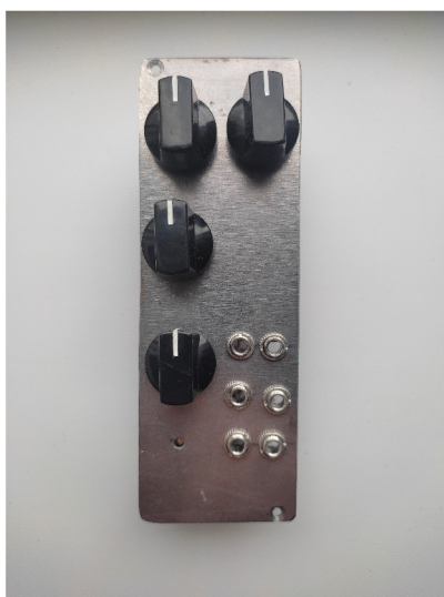
Obr. 2.12: Realizovaný modul generátoru tvarových kmitů
