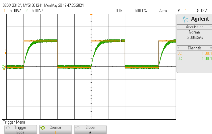
Obr. 7.11: Výstupní signál generátoru obálky, při nulové hodnotě parametru „Release“
