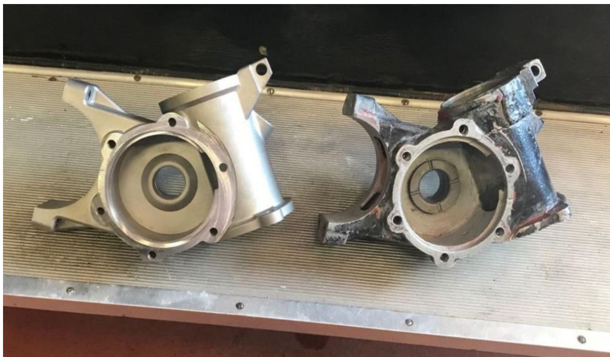
Obr. 20 Porovnání skříně řízení pro Ruston & Hornsby B2 [49]
