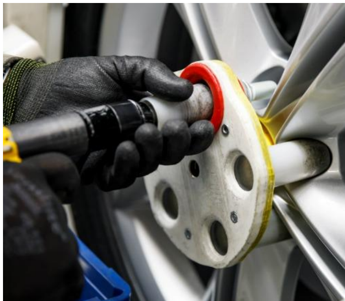
Obr. 17 Ochrana kol proti poškrábání [40]
