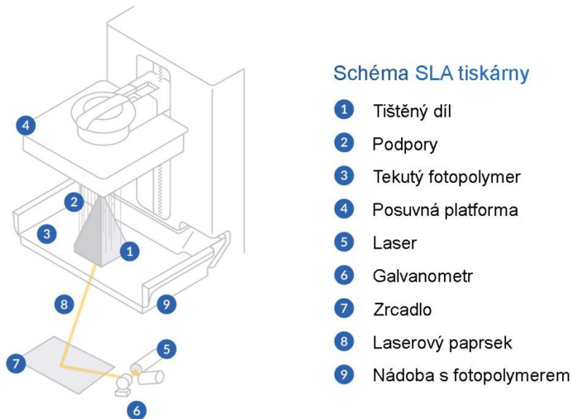
Obr. 8 Schéma SLA tiskárny [19]
