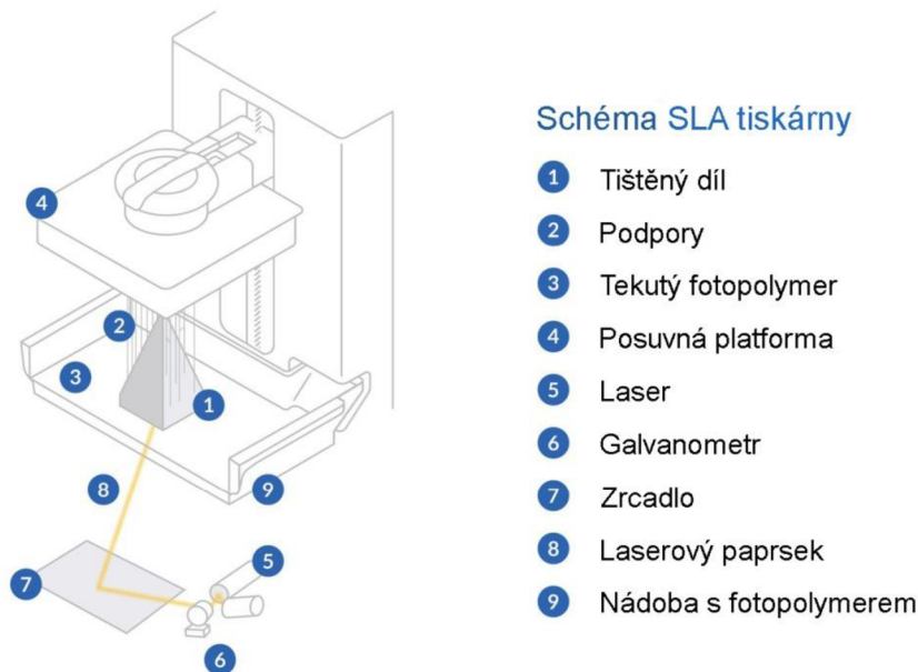
Obr. 8 Schéma SLA tiskárny [19]
