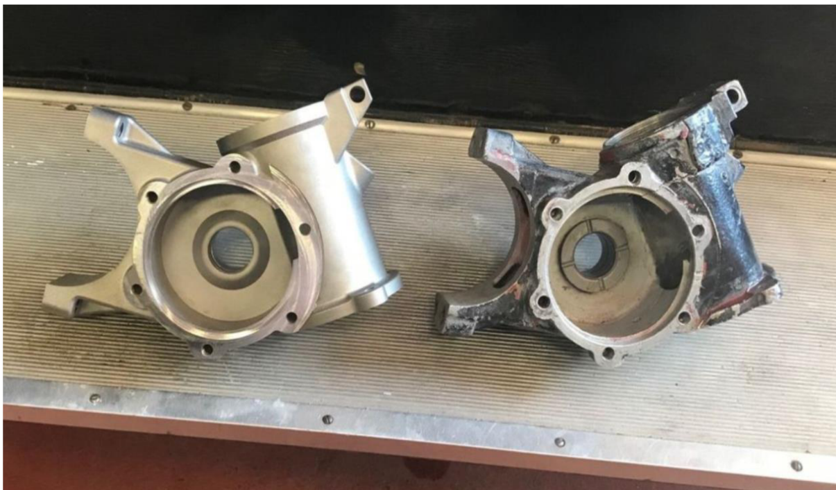
Obr. 20 Porovnání skříně řízení pro Ruston & Hornsby B2 [49]
