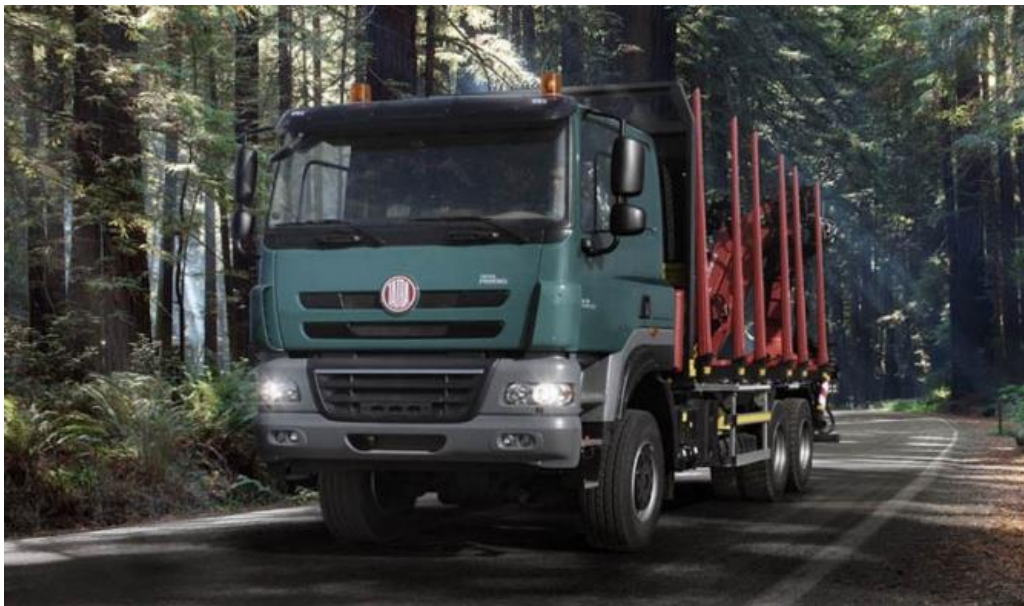
Obrázek 74 – Tatra T 158-8P5R33.451 6x6 vyvážec a přepravník dřeva [24]
