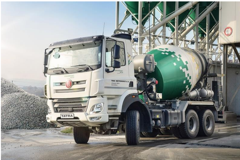
Obrázek 73 – Mobilní míchač Liebherr na podvozku Tatra Phoenix 6x6 T158-8P6R33.345 [24]
