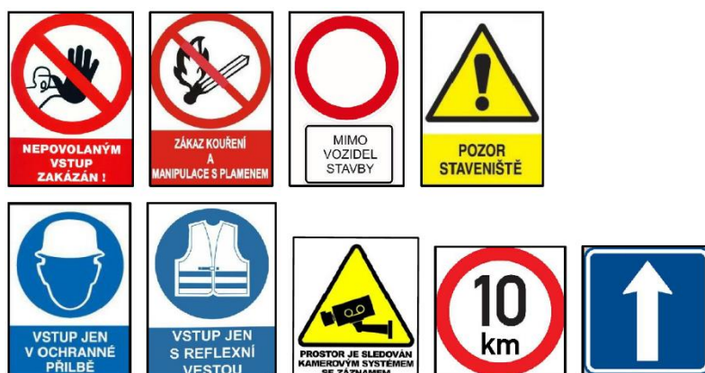
Obrázek 59 – Značení u vjezdu na staveniště [18]
