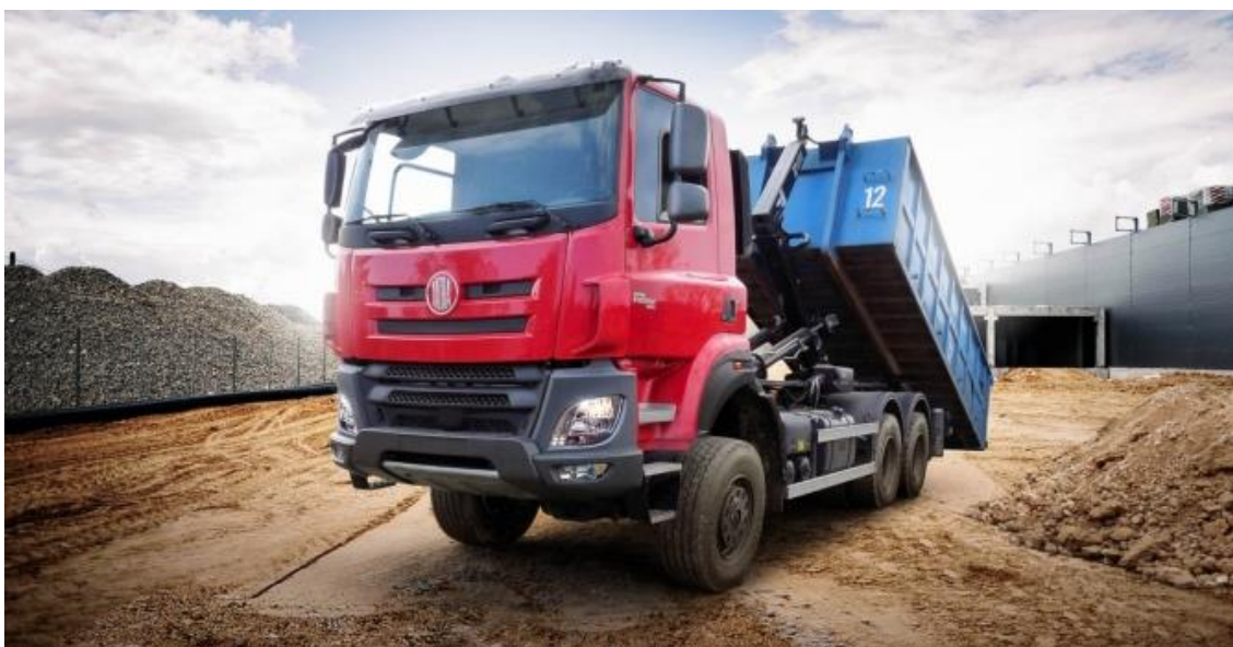
Obrázek 76 – Tatra T158-8P6R33.391 6×6 nosič kontejnerů s hákovým nakladačem [24]
