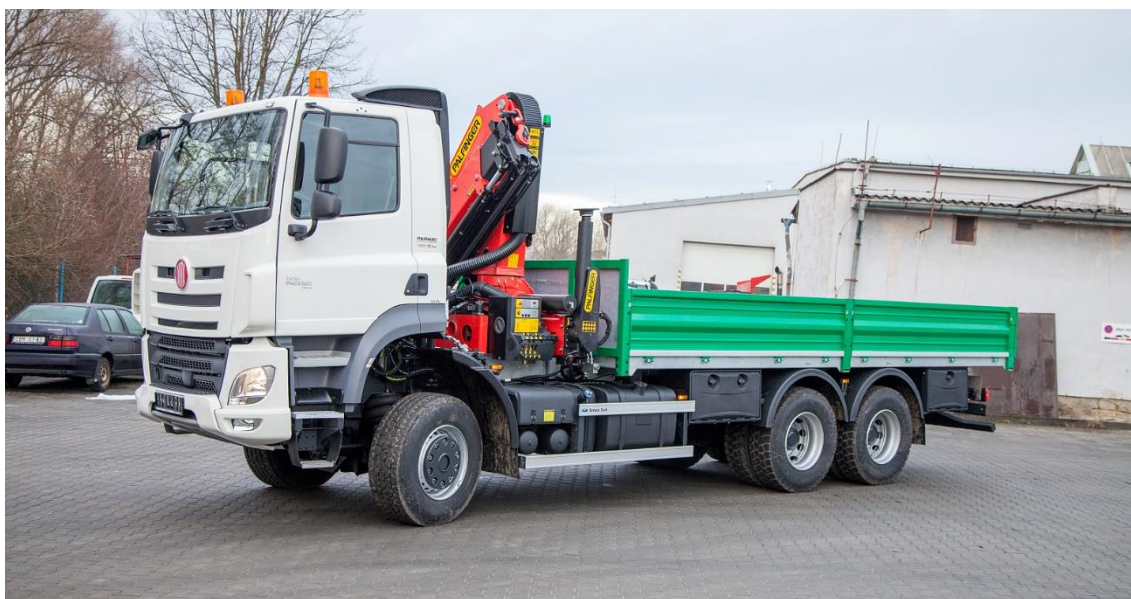
Obrázek 75 – Tatra PHOENIX 6×6.2 s valníkem a rukou HR Palfinger [24]
