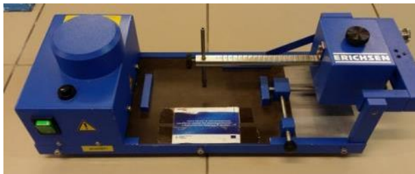
Obr. 7: Přístroj pro měření tvrdosti povrchu sklerometrickou metodou
