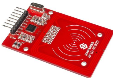
Obrázek 15 - RFID čtečka RC522 [63]
