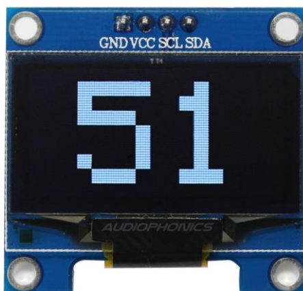
Obrázek 16 - 1,3 palcový OLED display SH1106 [64]
