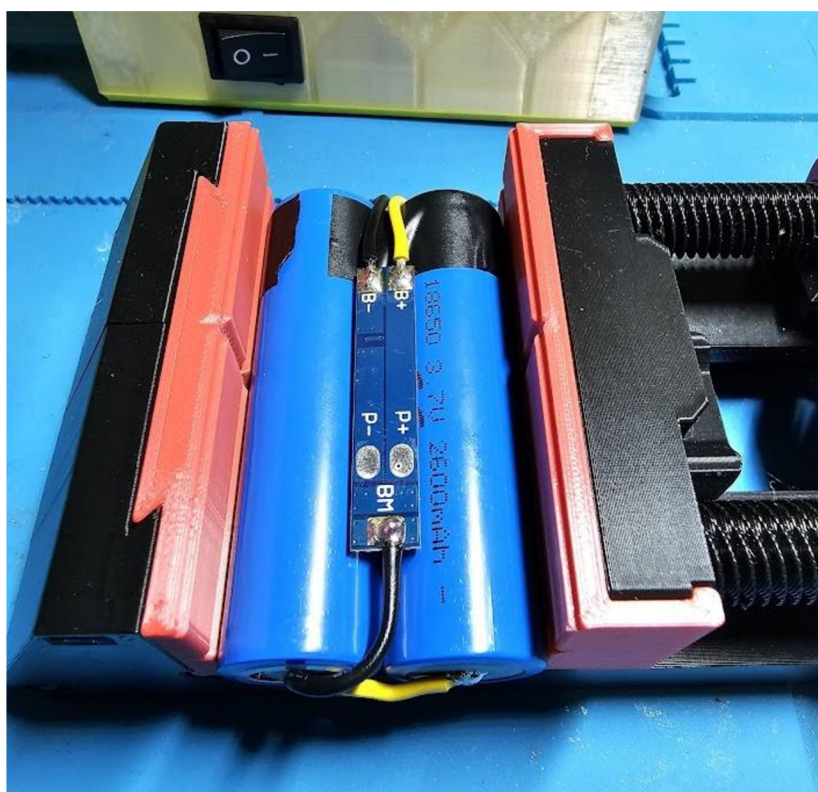
Obrázek 25 - Spojené akumulátory s přepětovou ochranou a balancérem umístěné v pájecím držáku vyrobeném s využitím FDM tiskárny
