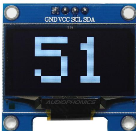
Obrázek 16 - 1,3 palcový OLED display SH1106 [64]
