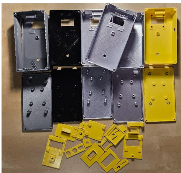
Obrázek 30 - Nezdařilé a testovací výtisky (žluté) s viditelnými verzovacími čísly.
