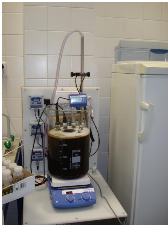
Obrázek 6: Příklad přístroje používaného pro přípravu výluhů stanovených v této bakalářské práci (Pomichálková, 2013)
