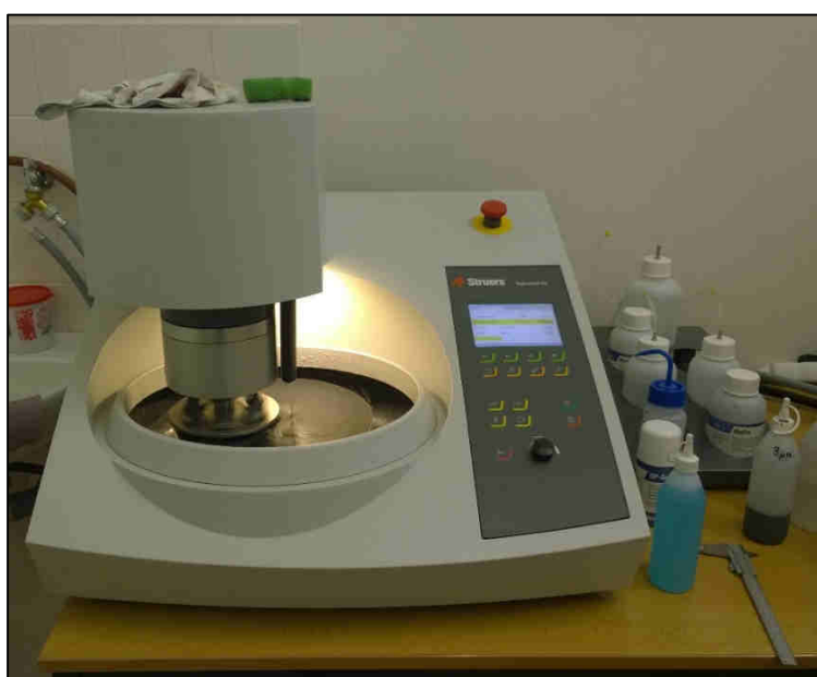
Obr. 23 Mechanický preparační systém Tegramin 25
