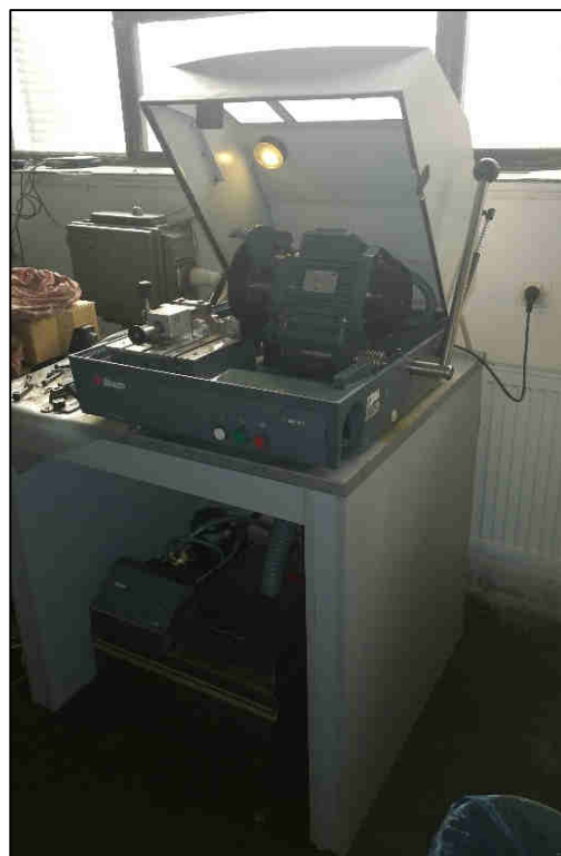
Obr. 19 Manuální stolní metalograf. rozbrušovací pila Labotom-3
