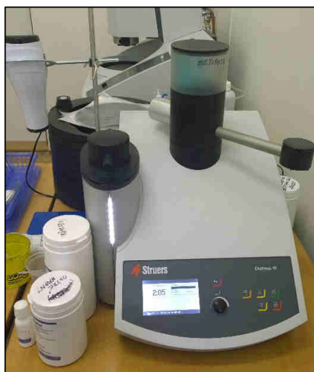
Obr. 21 metalografický lis CitoPress – 10
