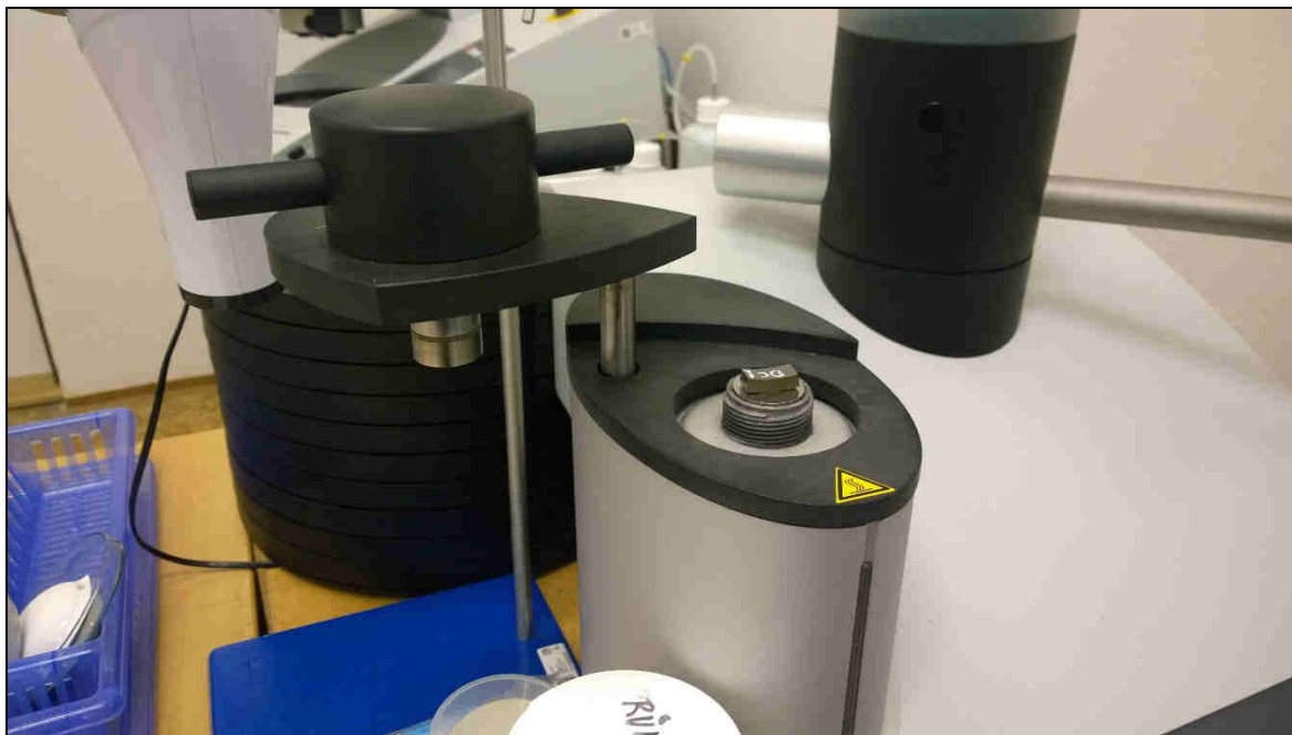
Obr. 36 Vzorek umístěný na píst metalografického lisu
