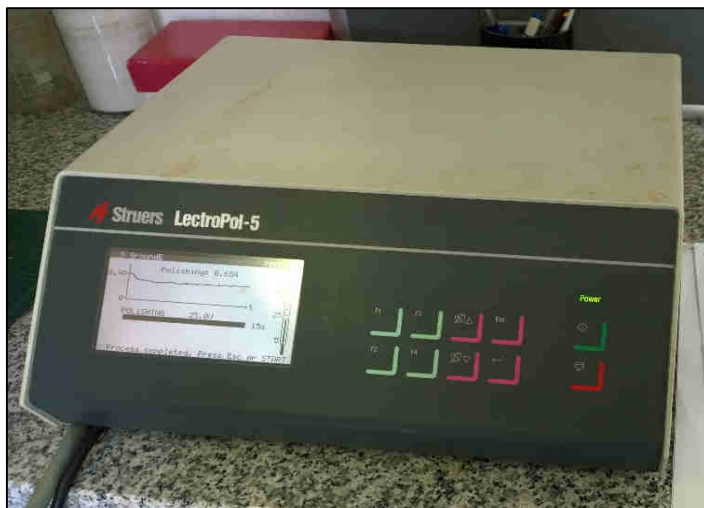
Obr. 28 Ovládací jednotka elektrolyt. leštičky (EL)
