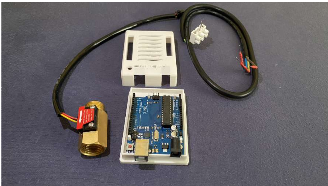
Obr. 6.3: Komponenty potrebné pre realizáciu pomocného zariadenia s využitím prietokomeru pre získavanie dát o aktuálnom prietoku teplej vody.
