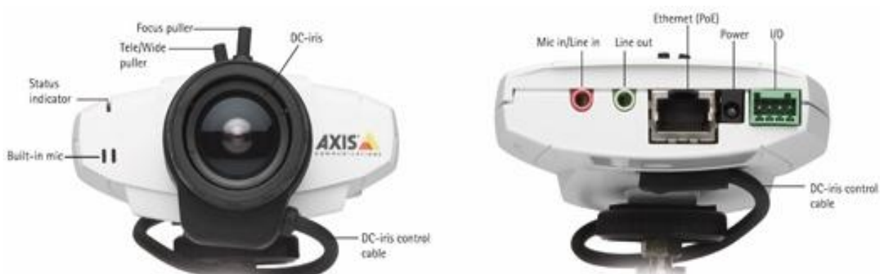
Obr. 6 IP kamera od společnosti AXIS Communications [20]
