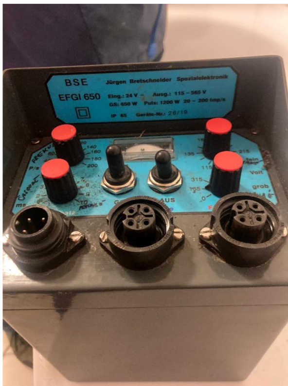
Příloha č. 1: Foto přenosného bateriového agregátu typu EFGI 650 (zdroj: Kabrt,2024)
