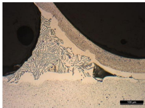
Obr. 48 Řez pájeným spojem[3]
