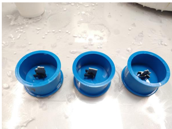
Obr. 78 Vzorky před zalitím
