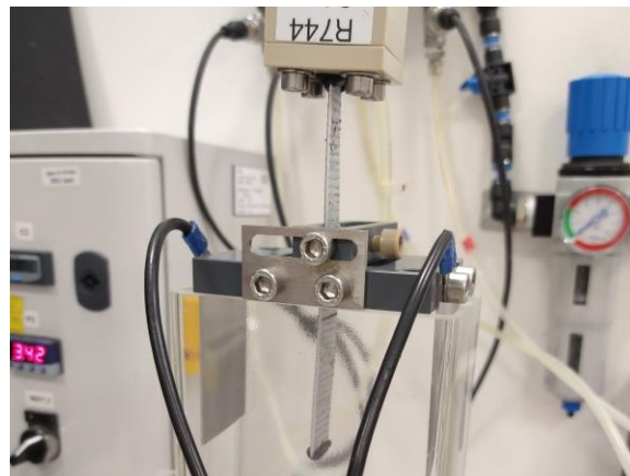
Obr. 77 Detail uchycení vzorku
