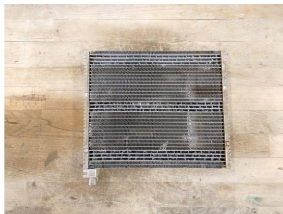
Obr. 71 IGC po odstranění finu
