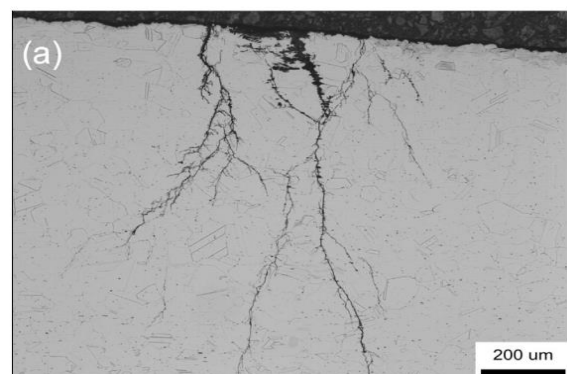
Obr. 38 Fotografie transkrystalové koroze [32]
