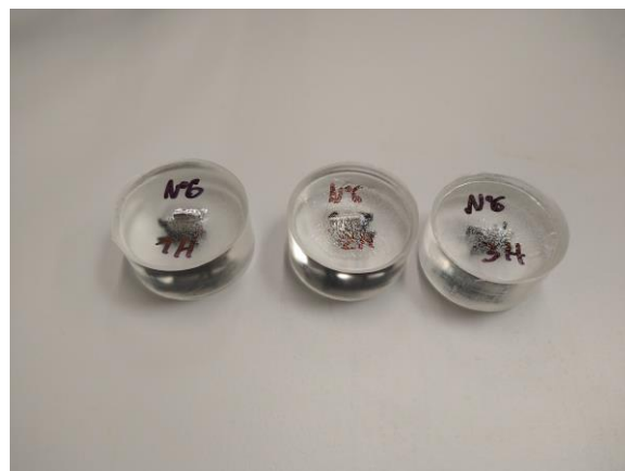
Obr. 79 Vzorky po zalití
