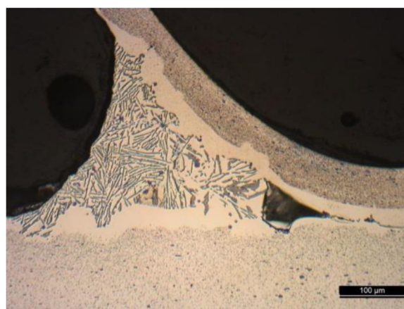
Obr. 48 Řez pájeným spojem[3]
