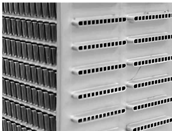
Obr. 44 Trubky zapájené v těle výměníku [37]
