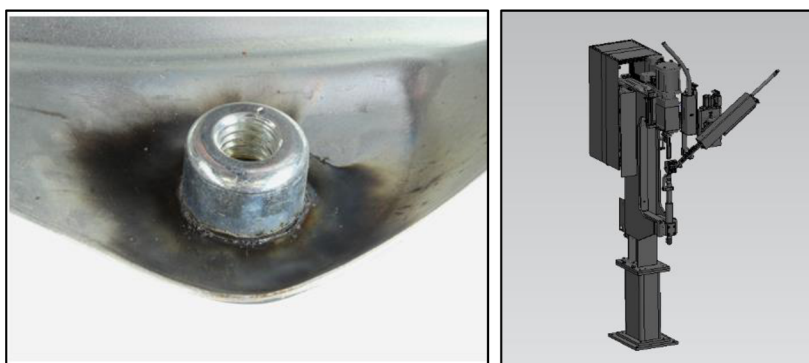
Obr. 5 – Bradavkové odporové svařování
