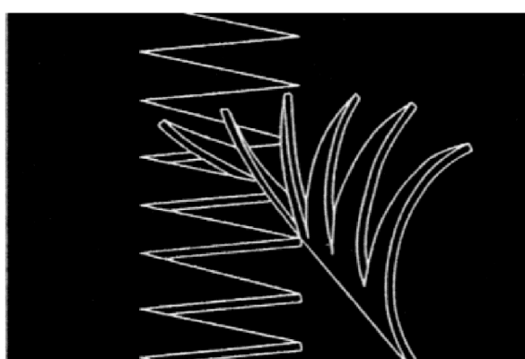
Obrázek 3.11 Prstový lepený spoj [1]
