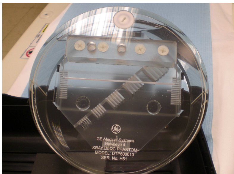
Obr. 3: Fantom pro denní zkoušku kvality na oddělení nukleární medicíny v Českých Budějovicích
