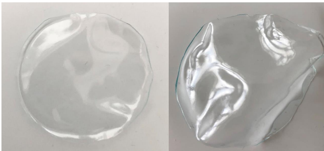
Obrázek 10 Suchý film (vlevo), film po 60 minutách botnání (vlevo)
