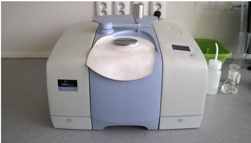
Obrázek 7 – Infračervený spektrometr Spectrum PerkinElmer 100 Series (Huntsman CoE)
