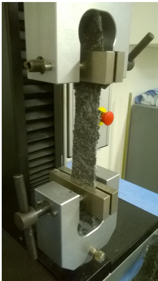
Obrázek 8 – Tahová zkouška na dynamometru
