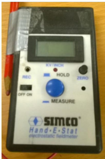
Obrázek 9 - Simco Hand.e.stat electrostatic fieldmeter
