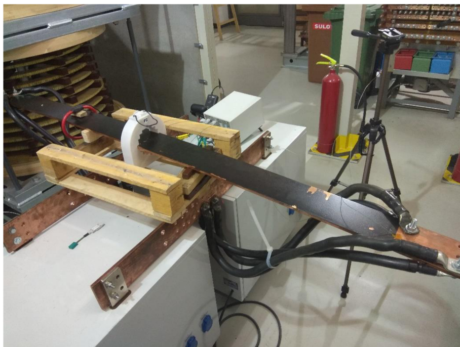
Obr. 6-2 Měření oteplovací zkoušky při orientaci primárního vodiče vodorovně
