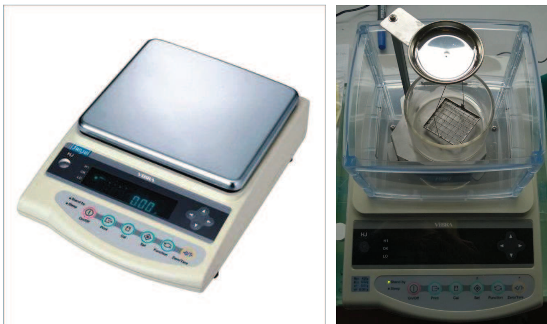
Obr. 3-3 Laboratorní váhy Vibra HJ series, vpravo s úpravou pro měření objemové hmotnosti imerzí metodou [38]
