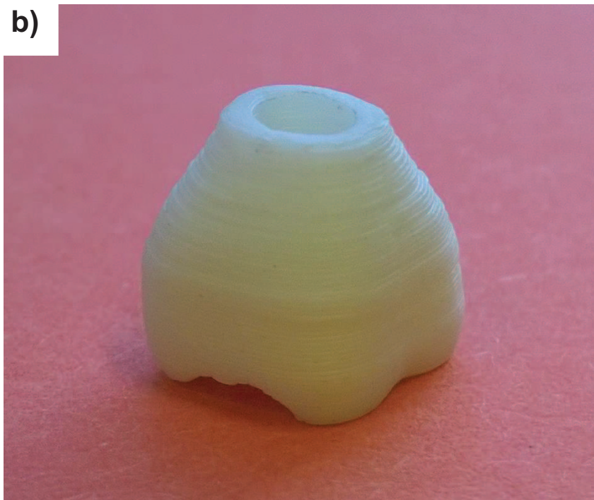
Obr. 3-11 a), b): Vytisknutá laterální zubní korunka po slinování
