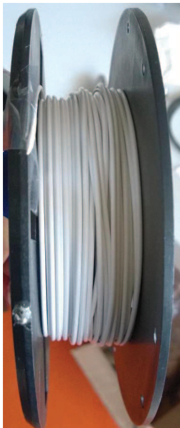
Obr. 3-18 Výsledný namotaný drát z keramického materiálu o vysokém podílu keramické složky
