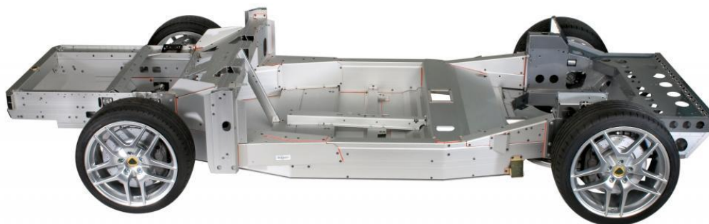
Obr. 7 – Hliníkový prostorový rám modelu Evora [38]
