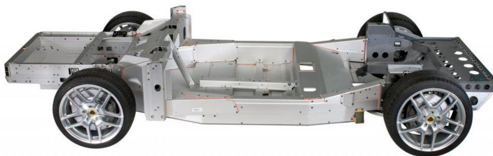
Obr. 7 – Hliníkový prostorový rám modelu Evora [38]
