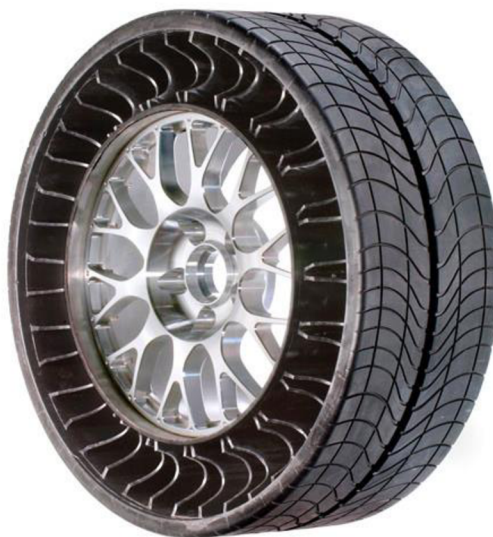
Obr. 21 – Bezvzduchová pneumatika určená pro testy [78]
