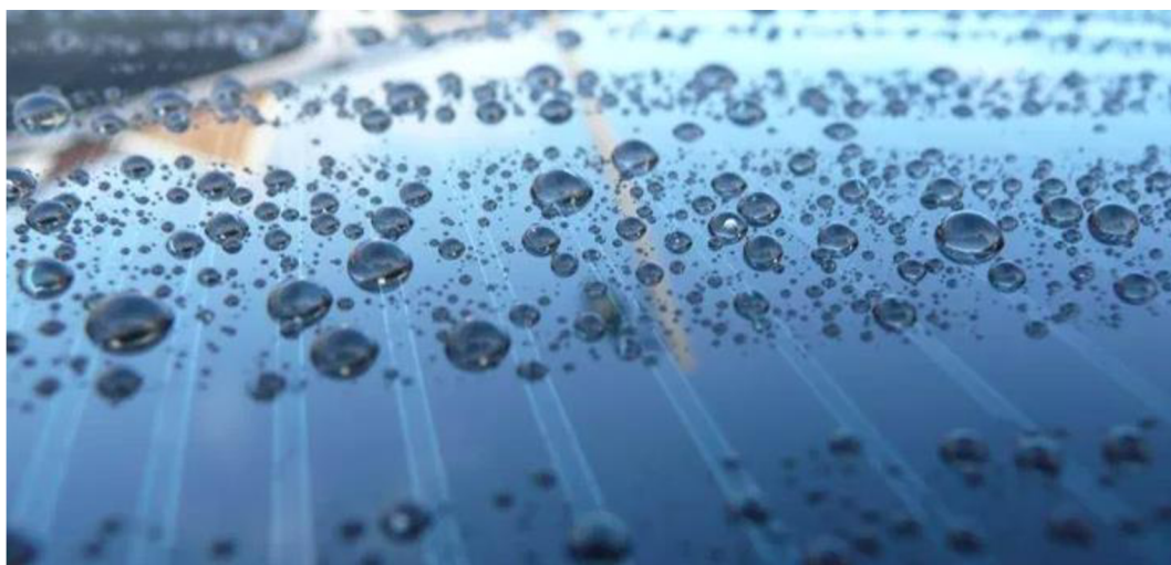
Obr. 10 – Funkce fluoridové vrstvy [22]
