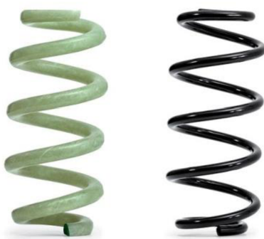
Obr. 18 – Srovnání kompozitní a ocelové pružiny [68]
