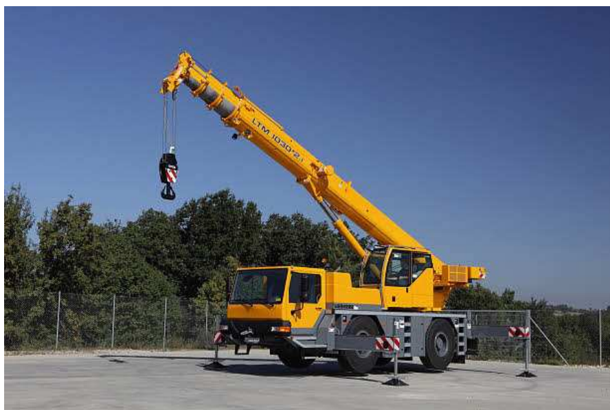
Obrázek 3.13: Způsob stabilizování jeřábu pomocí patek
