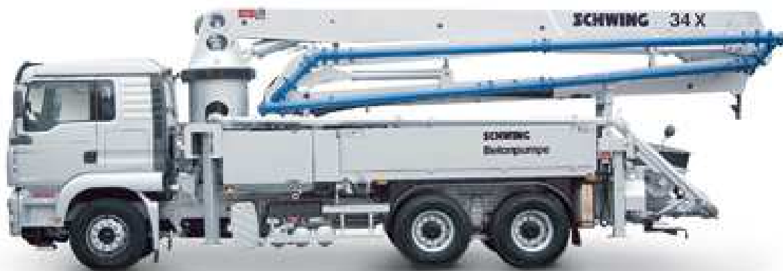
Obrázek 3.35: Autočerpadlo SCHWING S 34 X na podvozku MAN TGS 26.320
