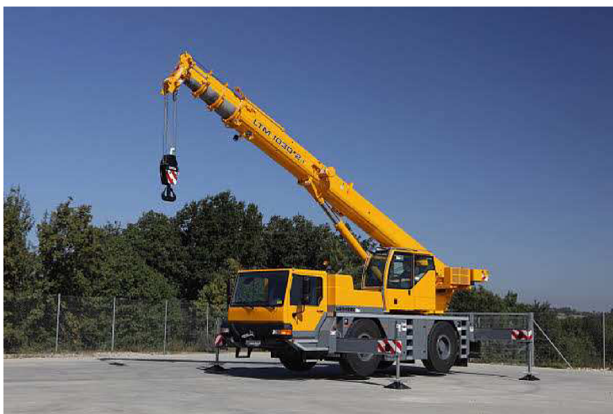
Obrázek 3.13: Způsob stabilizování jeřábu pomocí patek
