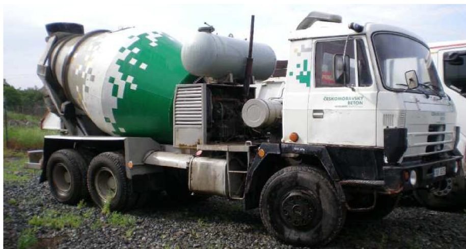
Obrázek 3.34: Autodomíchávač na podvozku Tatry 815
