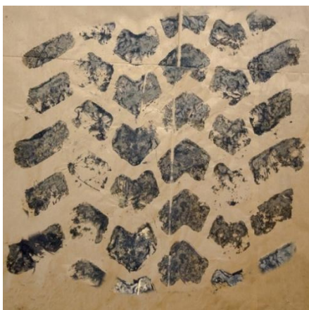
Obrázek 28 Michelin CargoXbib při huštění na 200 kPa
