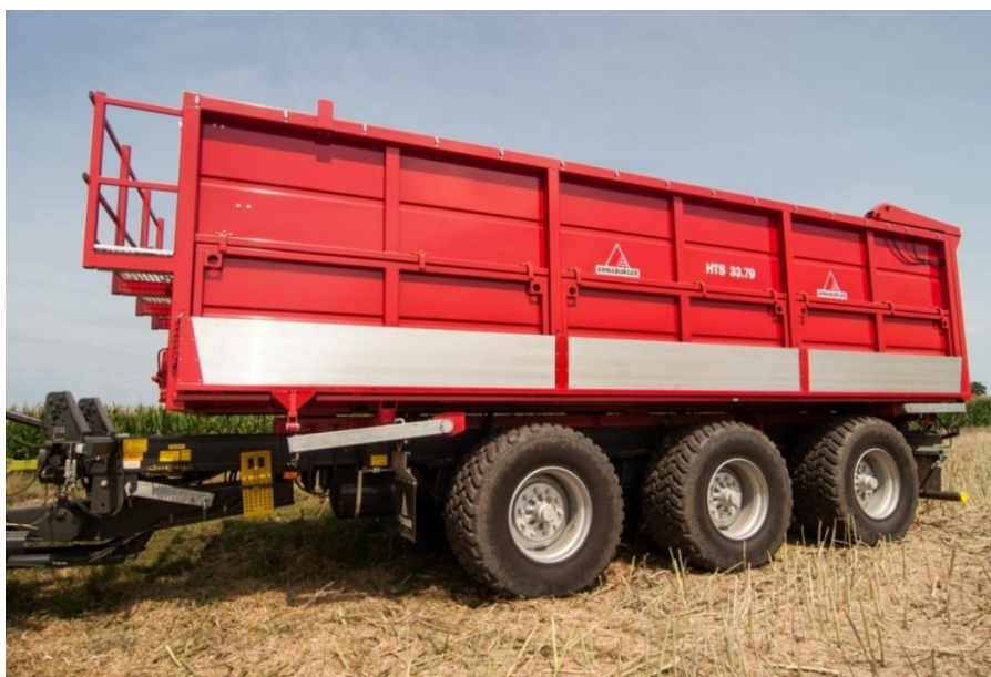
Obrázek 13 Podvozek Annaburger 33.79 vybavený hydraulicky odpruženou ojí
