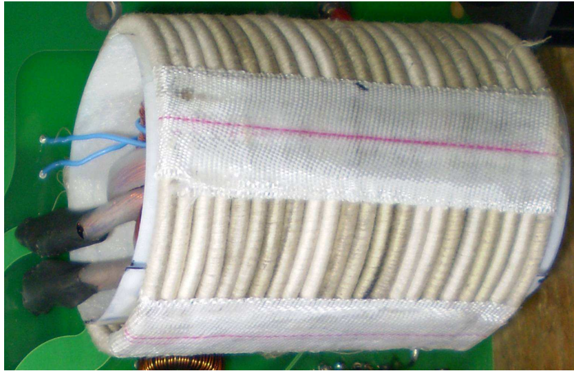
Obr. 9.1 Prevedenie vyhladovacej tlmivky navinutej na impulznom transformátore
