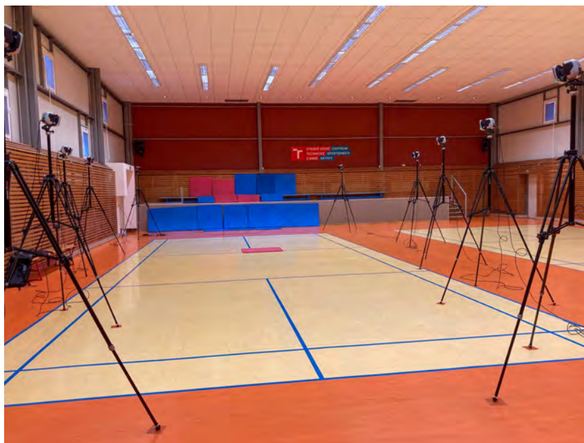
Obr. 2.4: Rozmístění kamer pro měření validity dat
