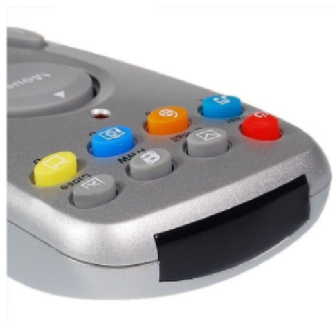
Obr. 2.26: Vysielač infračerveného žiarenia na ovládači.
