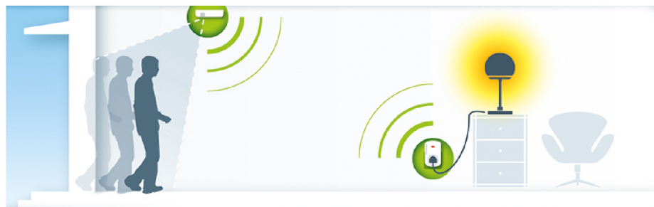
Obr. 2.40: Princíp nepriameho pasívneho ovládania svetla.
