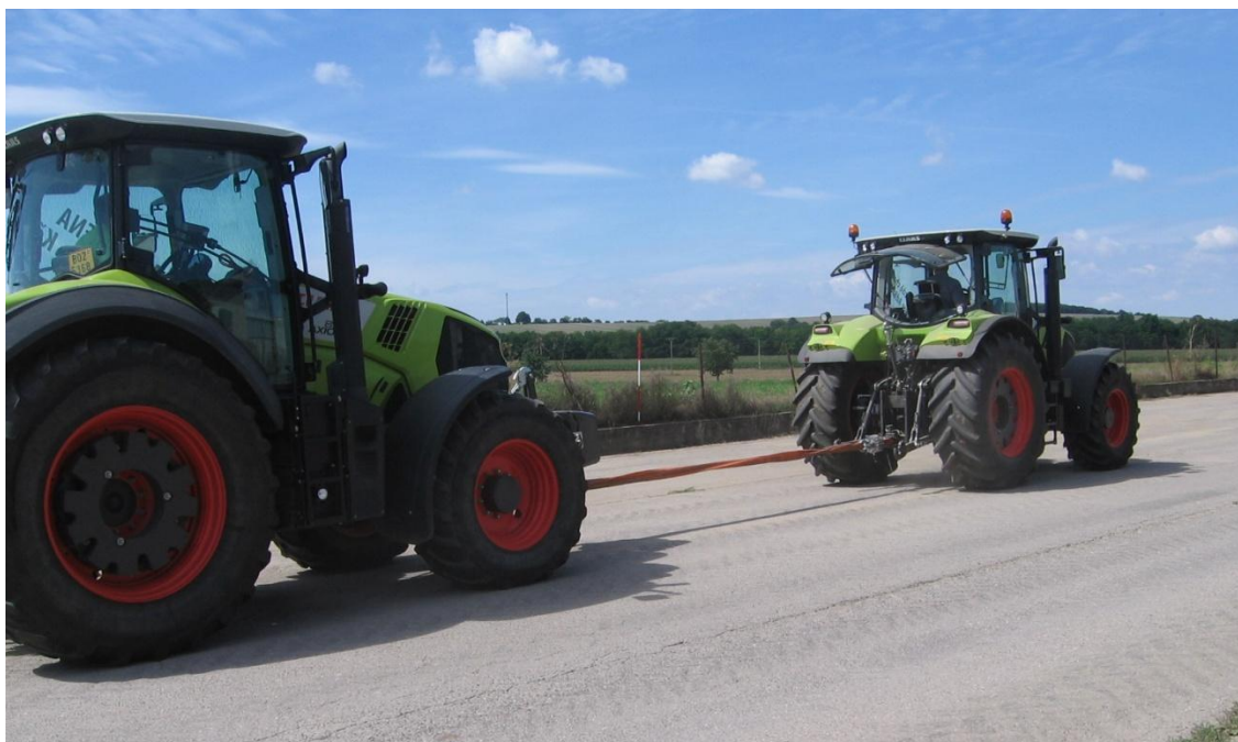
Obrázek 29: Tahové zkoušky traktoru Claas Arion 640 na asfaltové vozovce [20]
