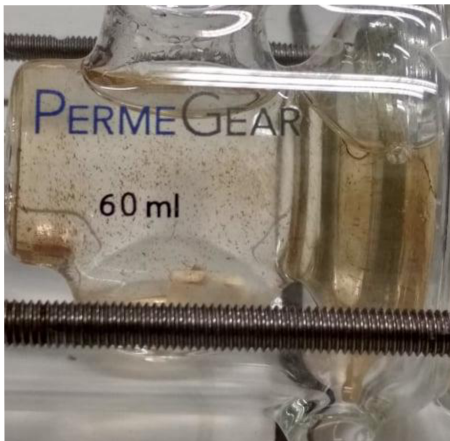
Obrázek 40: Agregáty mezi LHK a Septonexem pozorované po 4 týdnech difúzního (dialyzačního) procesu v přijímací komoře difúzní cely
