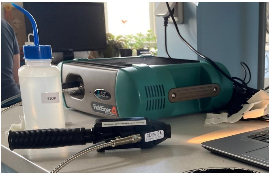
Obrázek 6 - Spektroradiometr ASD FieldSpec4 firmy Malvern Panalytical a kontaktní sonda; dokumentace měření reflektance na Univerzitě Karlově v Praze, srpen 2021
