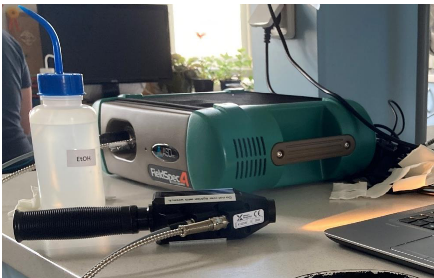
Obrázek 6 - Spektoradiometr ASD FieldSpec4 firmy Malvern Panalytical a kontaktní sonda; dokumentace měření reflektance na Univerzitě Karlově v Praze, srpen 2021
