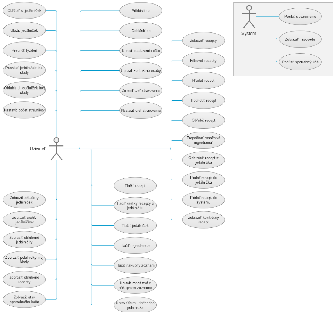
Obrázek 5.4: Výsledný use-case diagram. Najťažšou úlohou bolo spracovať podobu a zobrazovanie aktuálneho jedálnička a podrobností o jedálničku, keďže jedálniček predstavuje element systému, ktorý obsahuje pomerne veľké množstvo údajov.
