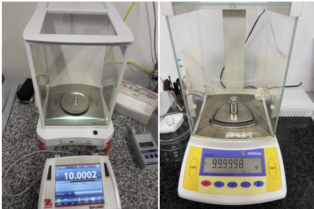
Obrázek 8.4 Váhy značky Ohaus Explorer 224 a Sartorius CP225D na půdě VUT
