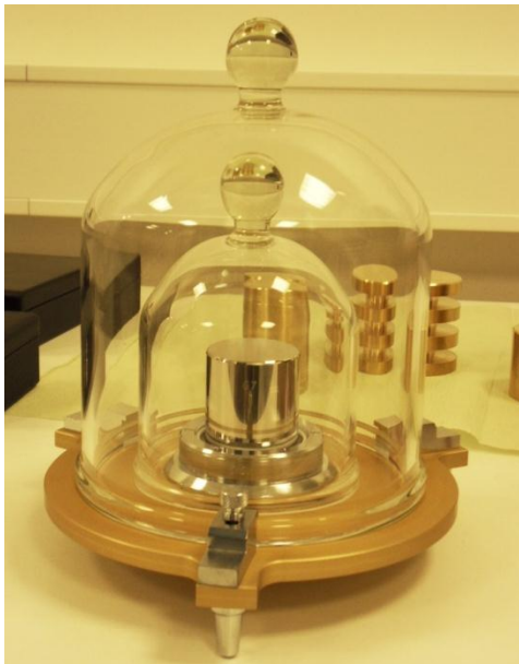
Obrázek 8.3 Státní etalon hmotnosti č. 67 a dvě etalonová závaží 1kg z austenitické oceli
