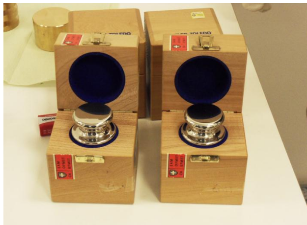
Obrázek 8.3 Státní etalon hmotnosti č. 67 a dvě etalonová závaží 1kg z austenitické oceli
