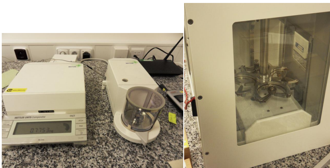
Obrázek 8.5 Mikrováhy Mettler Toledo UMT5 a komparátor Mettler Toledo AT1006
