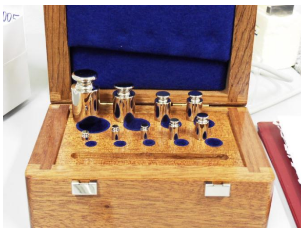
Obrázek 8.1 Sada závaží Radwag třídy přesnosti E2
