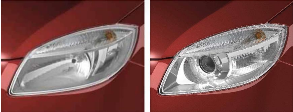
Obr. 13 Porovnání halogenového reflektorového a projektorového světlometu
